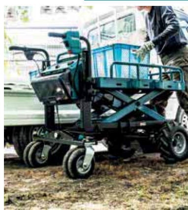
Elektrischer Lift. Höhenverstellbar von 475 bis 1.020 mm
